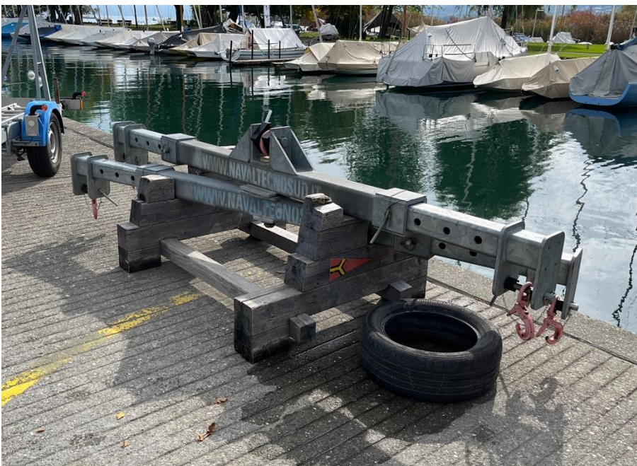
Abbildung 2, Lagerung der Lasttraverse
